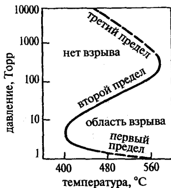
Рис. 6.12. Взрывные пределы для стехиометрической смеси кислорода с водородом
